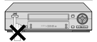
Ce magnétoscope règle l'horloge et les canaux du tuner automatiquement quand le cordon d'alimentation secteur est branché pour la première fois sur une prise secteur. Le câble d'antenne doit être connecté pour que le réglage automatique fonctionne.
